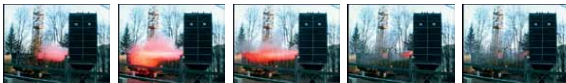
Explosionsversuche bei der FSA an Filtergehäusebaureihe
