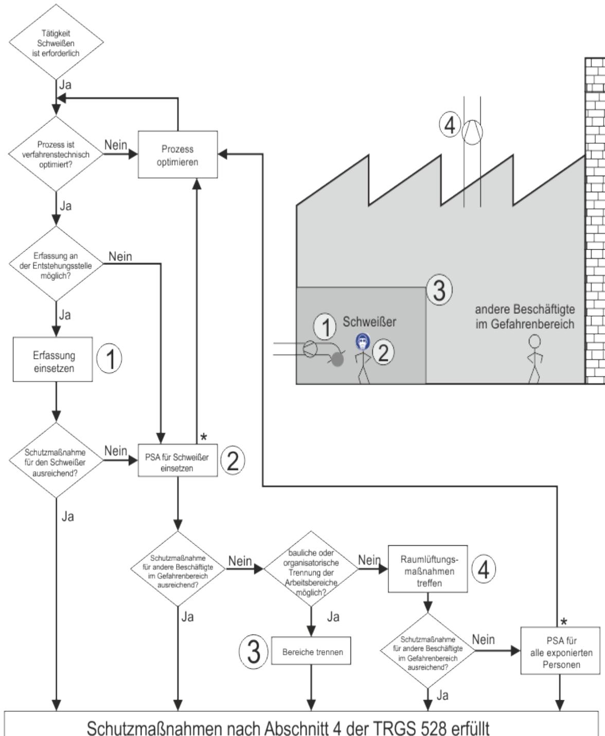
**Abbildung 2:** Fließdiagramm zur Auswahl von Schutzmaßnahmen bei schweißtechnischen Arbeiten.
